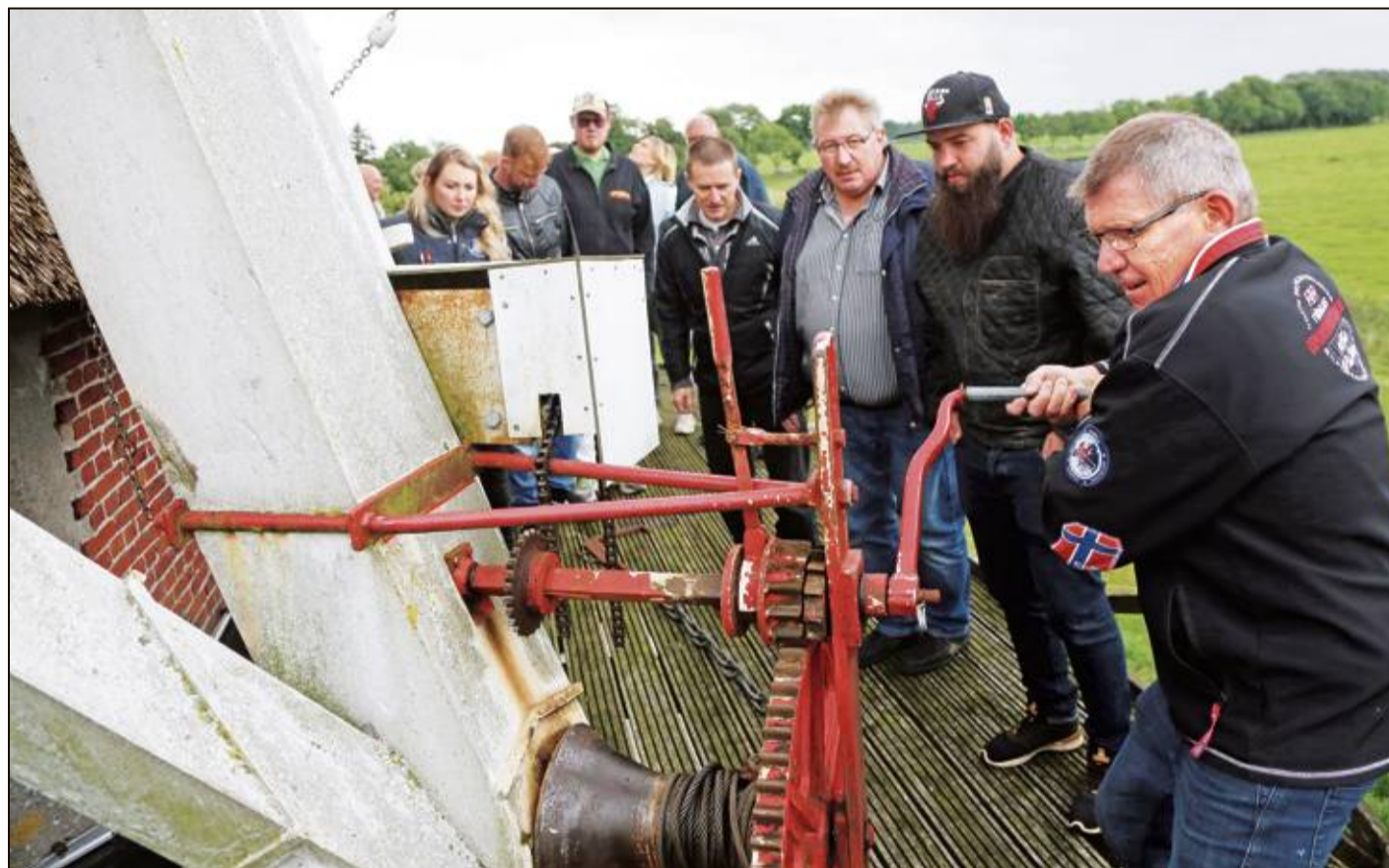
Mit Muskelkraft drehten die angehenden freiwilligen Müller das Flügelkreuz samt Kappe der Sengwarder Mühle in die richtige Windrichtung.
